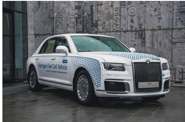
Рис. 1. Внешний вид автомобиля с гибридной энергетической установкой на основе водородного топливного элемента и аккумулятора
