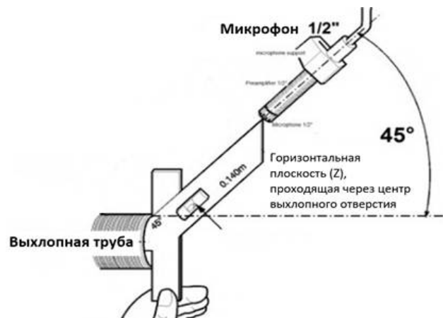
Рис. 4. Схема установки измерительного микрофона
