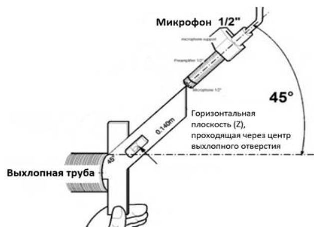
Рис. 4. Схема установки измерительного микрофона
