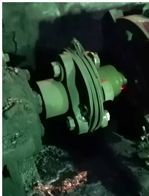
Рис. 4. Упругая муфта приводе валков при проведении испытаний
