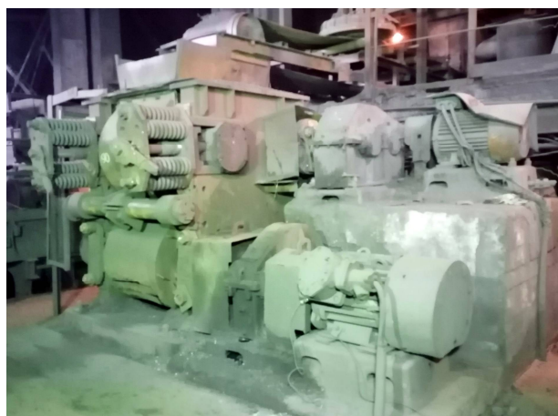
Рис. 5. Четырехвалковая дробилка ДЧГ 900×700 [11] в приводе валков при проведении испытаний
