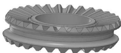
Рис. 2. Вариант двухвального конического сателлита
