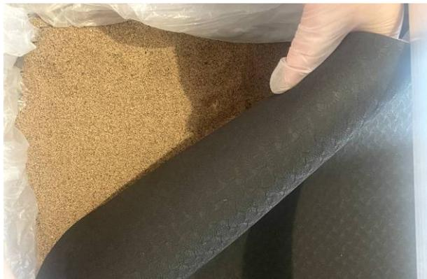
Рис. 10. Размещение ленточного элемента поверх материала
