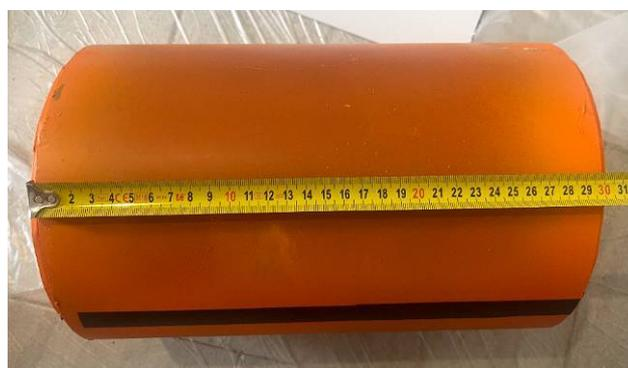
Рис. 7. Модель вальца многократного воздействия шириной 300 мм и диаметром 210 мм
