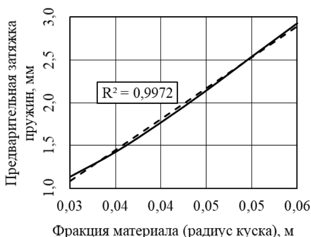
Рис. 2. Зависимость предварительной затяжки комплекта пружин амортизационного устройства верхних валков дробилки ДЧГ 900×700 при дроблении кокса доменного
