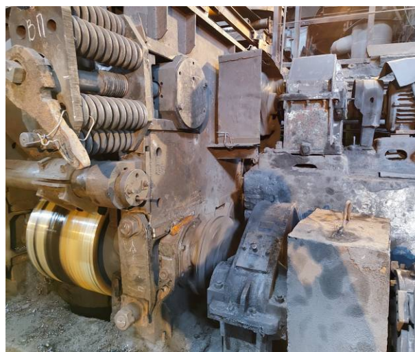
Рис. 4. Четырехвалковая дробилка ДЧГ 900×700 в условиях проведения испытаний способа регулирования затяжки комплекта пружин амортизационного устройства
