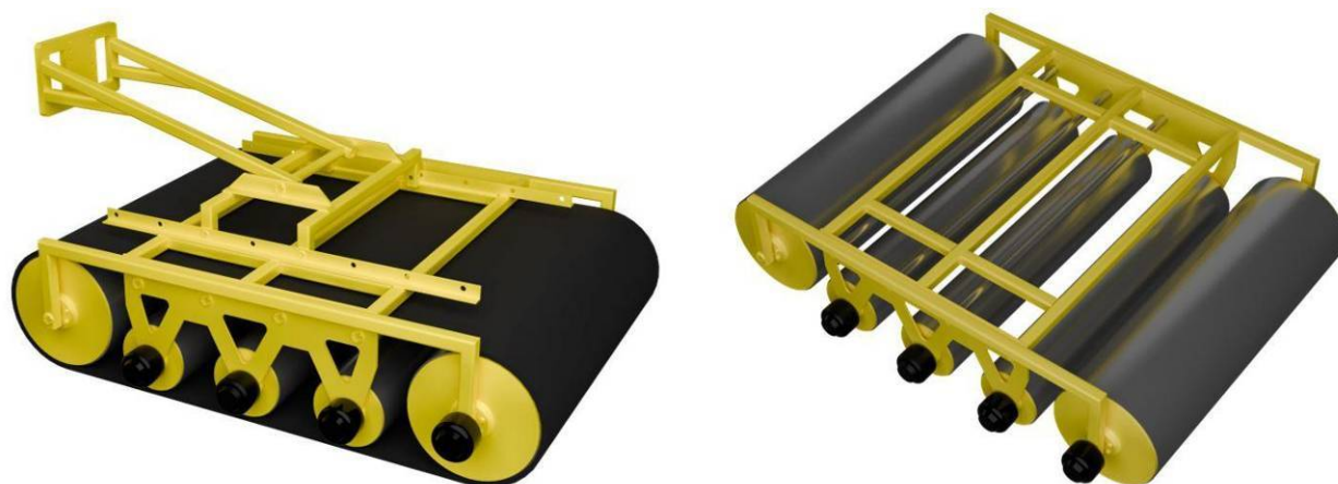
Рис. 2. Общий вид конструкции и рабочих органов комбинированного уплотняющего оборудования
