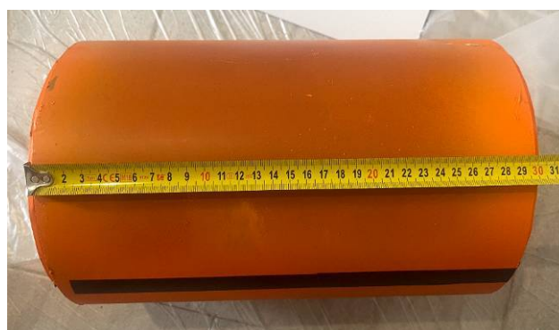
Рис. 7. Модель вальца многократного воздействия шириной 300 мм и диаметром 210 мм
