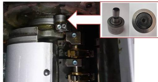
Рис.5. Расположение опорного ролика
