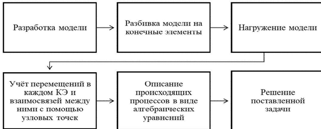
Рис.6. Решение задачи с помощью метода конечных элементов
