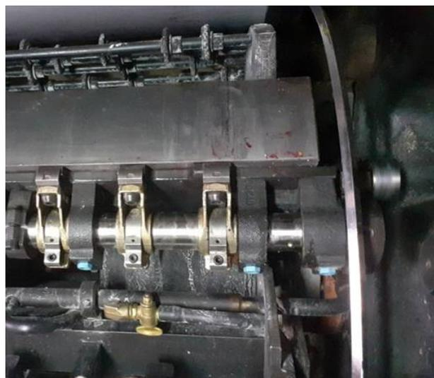
Рис.1. Система захватов
