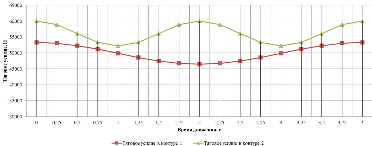
Рис. 6. Графики изменения тяговых усилий в гусеничных контурах во времени (расчетные случаи 2 и 3)
