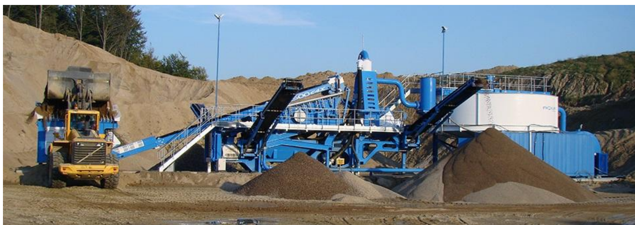
Рис. 3. Мобильный моющий завод CDE M2500
