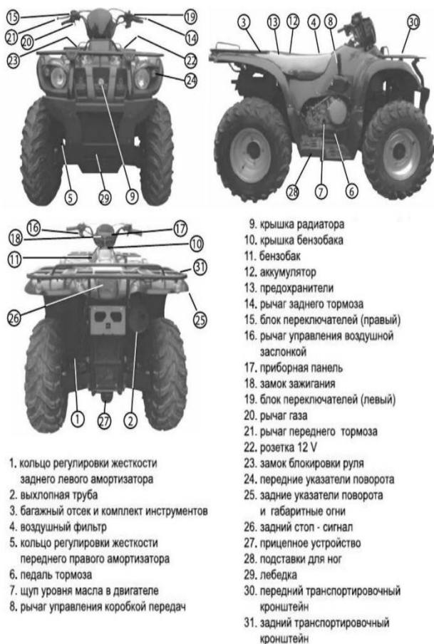
Рис. 4. Составные узлы, агрегаты и комплектация квадроцикла
