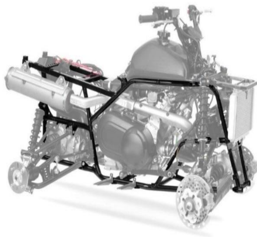
Рис. 2. Рама квадроцикла с размещением узлов и агрегатов
