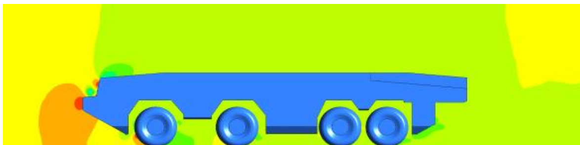
Рис. 3. Пример визуализации результатов CFD-моделирования КСКШ: а – распределение скоростей потока воздуха при обтекании корпуса специального колесного шасси; б – распределение полей давления при обтекании корпуса специального колесного шасси (в среднем сечении); в – распределение полей давления при обтекании корпуса специального колесного шасси (в сечении колесной колеи)
