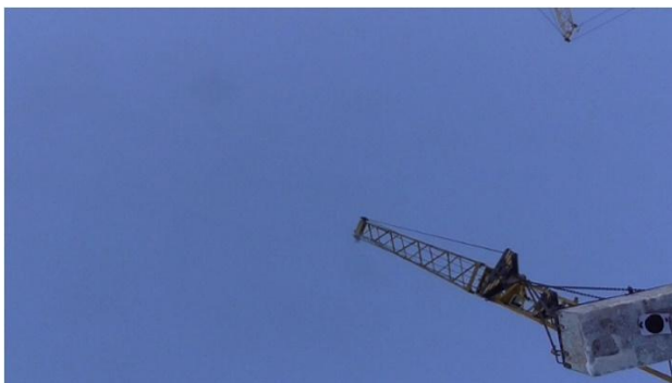
Рис. 7. Изображение в объективе камеры при проведении экспериментальных исследований по определению углов раскачивания груза при перемещении крана ДЭК-251 (пример)
