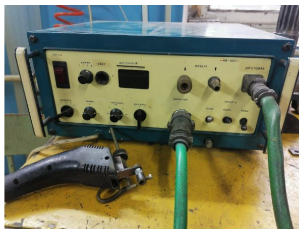
Рис. 2. Общий вид установки для электроискровой обработки поверхности деталей «Вестрон» тип АИ-007
