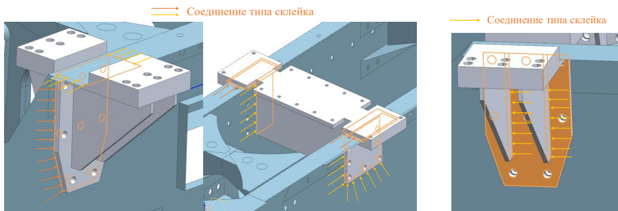
Рис. 5. Моделирование соединений кронштейнов: а – соединение кронштейнов с лонжеронами рамы; б – соединение составных частей кронштейнов
