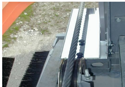
Рис. 14. Проверка каната с использованием зеркала при визуально-измерительном контроле
