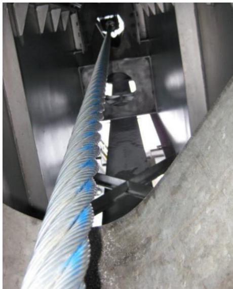
Рис. 15. Сплошная горизонтальная линия для контроля осевого кручения несуще-тягового каната
