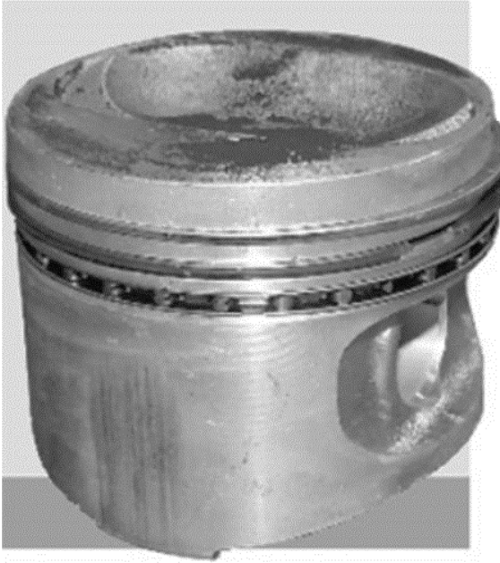
Рис. 4. Характерный износ юбки поршня от воздействия боковой силы
