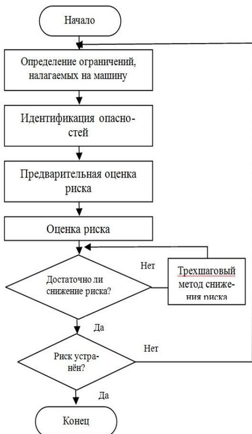
Рис. 1. Схема трехшагового метода снижения риска [10]
