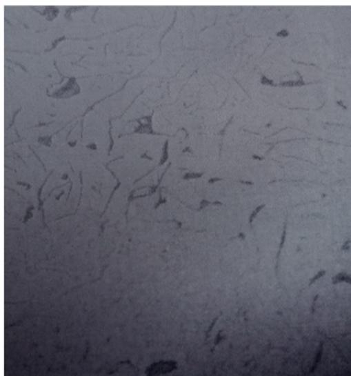
Рис. 3. Микроструктура слоя после окисления  $Cr_2O_3$  x400
