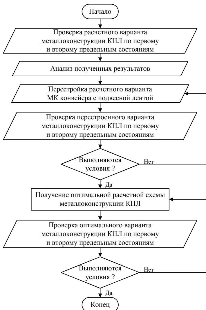
Рис. 4. Этапы оптимального проектирования металлоконструкции стационарного КПЛ
