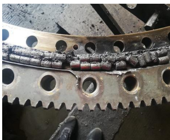
Рис. 4. Отказ опорно-поворотного устройства в результате выпадения тел качения
