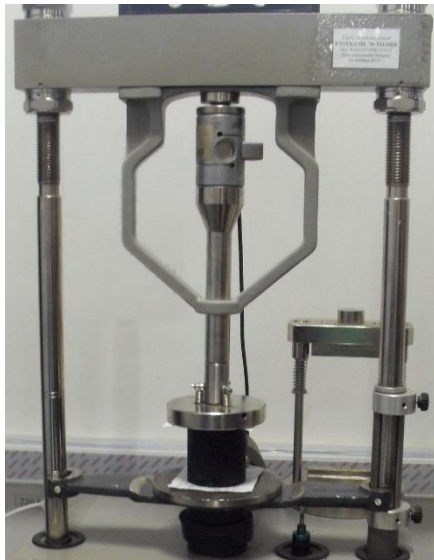
Рис. 5. Общий вид электромеханического пресса
