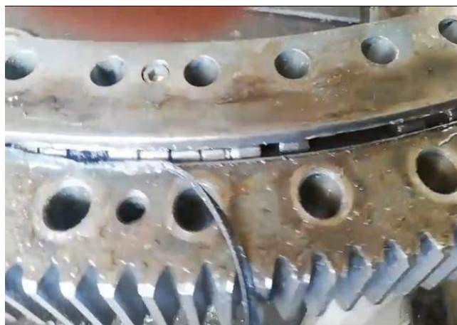
Рис. 4. Отказ опорно-поворотного устройства в результате выпадения тел качения
