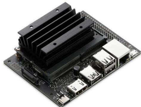
Рис. 5. Встраиваемый модуль NVIDIA Jetson Nano
