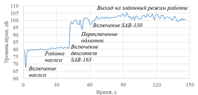
Рис. 2. Изменение уровня шума по этапам запуска компрессорного агрегата
