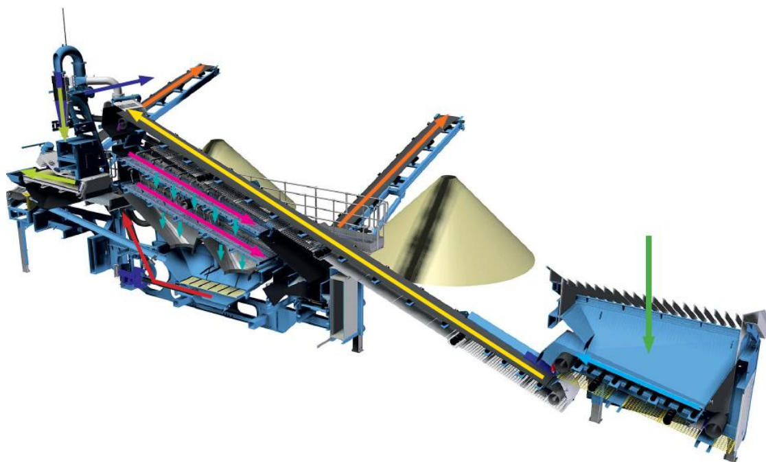
Рис. 4. Конструкция мобильного моющего завода CDE M2500 в разрезе
