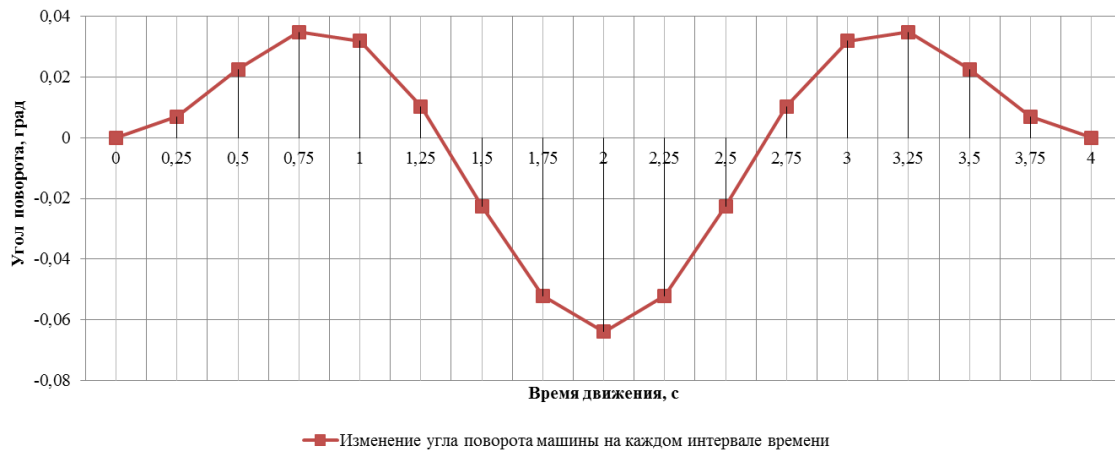
Рис. 8. График изменения угла поворота машины во времени
