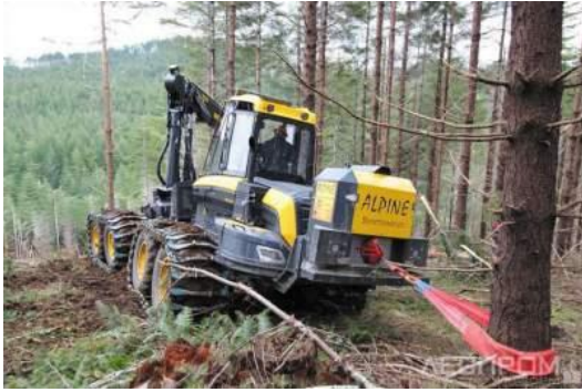
Рис. 1. Машина для лесозаготовки на склоне, оборудованная лебедкой
