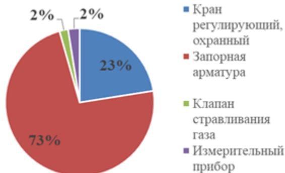
Рис. 3. Доля утечек по оборудованию при транспортировке газа от плавучей регазификационной установки к подземному хранилищу
