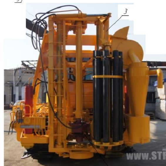
Рис. 1. Буровой тракторный станок БТС-150: 1 – базовый трактор; 2 – основная рама; 3 – буровая рама; 4 – механизм вращения бурового става
