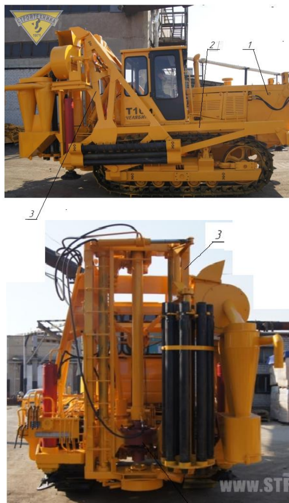
Рис. 1. Буровой тракторный станок БТС-150: 1 – базовый трактор; 2 – основная рама; 3 – буровая рама; 4 – механизм вращения бурового става
