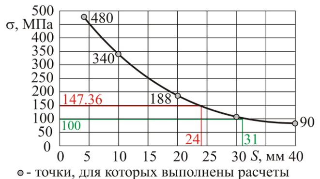
Рис. 10. Зависимость максимальных эквивалентных напряжений в газопроводе в зависимости от  $S$
