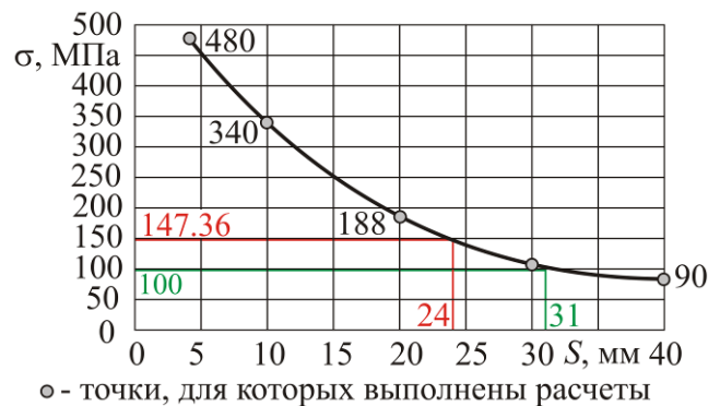
Рис. 10. Зависимость максимальных эквивалентных напряжений в газопроводе в зависимости от S
