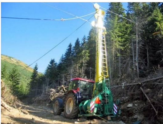
Рис. 1. Канатные транспортные системы: а – стационарная подвесная канатная дорога; б – мобильный транспортно-перегрузочный канатный комплекс для лесозаготовки
