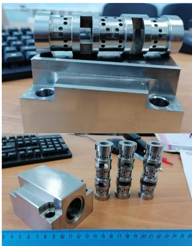
Рис. 16. Модернизированная гильза и корпус гидравлического распределителя
