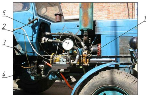
Рис. 2. Общий вид компоновки элементов упруго-демпфирующего механизма на тракторе:
