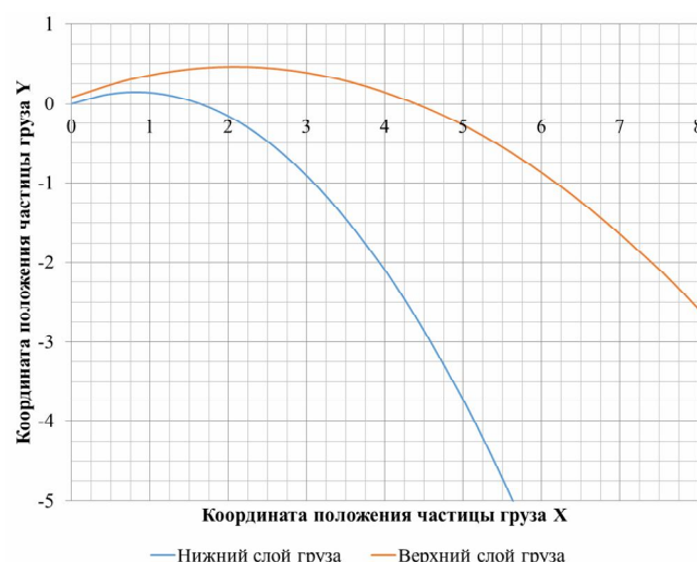
Рис. 6. Траектории движения груза при \beta = 20^\circ :
