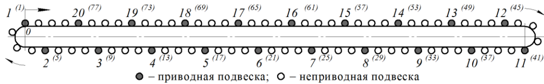
Рис. 6. Схема исходного расположения ведущих и ведомых подвесок на трассе конвейера с подвесной лентой и распределенным приводом
