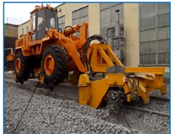
Рис. 1. Комплекс путевой универсальный КПУ-1: 1 – базовая машина; 2 – щеточный подборщик
