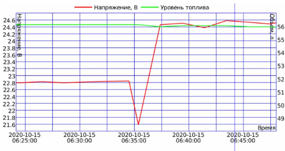
Рис. 8. Копия окна системы мониторинга дорожной машины при трудном запуске двигателя во время работы дорожной машины
