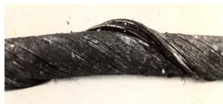
Рис. 9. Выход из замка наружных проволок несущего каната
