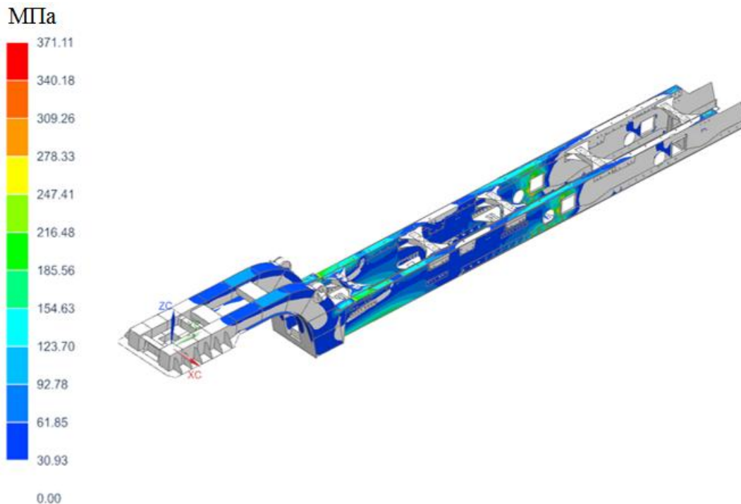
Рис. 9. Распределение эквивалентных напряжений в металлоконструкции (режим I)
