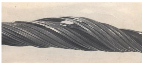
Рис. 10. Расслоение (отслоение проволок наружного слоя) несущего каната закрытой конструкции
