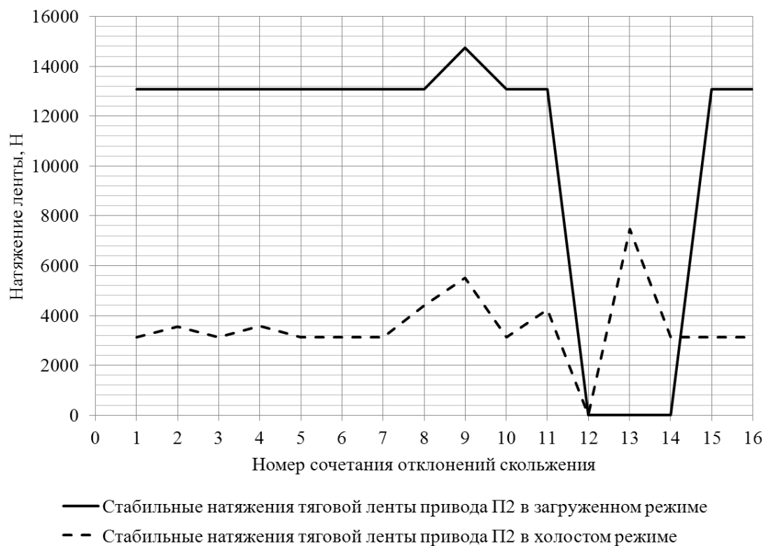
Рис. 3. Натяжения тяговой ленты привода П2
