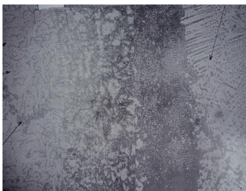
Рис. 8. Микроструктура сварного шва, x500
