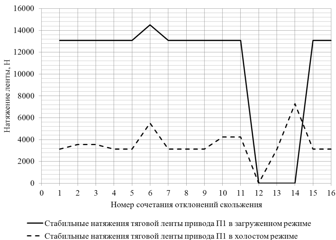
Рис. 2. Натяжения тяговой ленты привода П1
