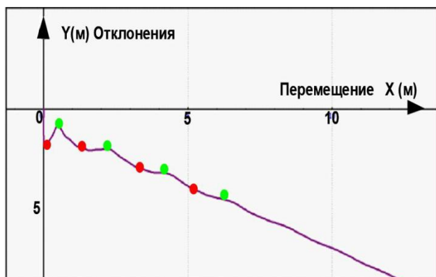
Рис. 5. График неустойчивого движения трицикла на склоне 25^\circ с моментами отрыва колеса от опорной поверхности (● – отрыв верхнего по склону колеса задней оси от опорной поверхности; ● – возвращение верхнего по склону колеса задней оси на опорную поверхность)
