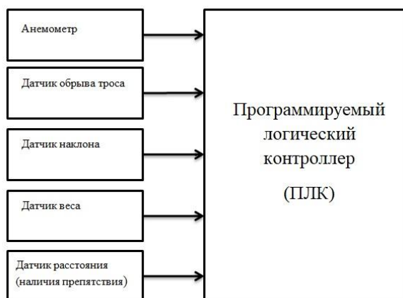
Рис.1. Взаимодействие датчиков безопасности при подъеме крана
