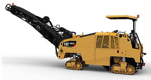
Рис. 1. Мобильные строительные и дорожные машины с отвальными конвейерами: а – дорожная фреза Caterpillar PM310 [3]; б – промывочно-сортировочная установка CDE R2500 [4]
