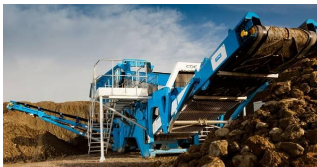
Рис. 1. Мобильные строительные и дорожные машины с отвальными конвейерами: а – дорожная фреза Caterpillar PM310 [3]; б – промывочно-сортировочная установка CDE R2500 [4]
