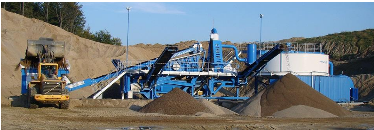
Рис. 3. Мобильный мойющий завод CDE M2500 [4]
