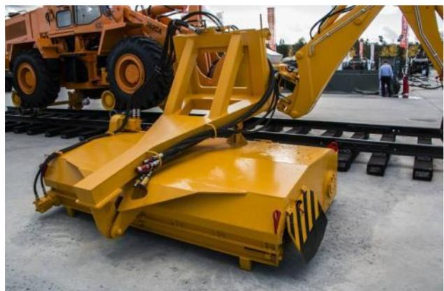
Рис.2. Блок очистки верхней постели шпал
