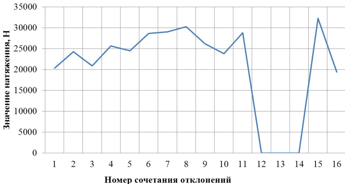
Рис. 6. Максимальные натяжения грузонесущей ленты, полученные по результатам вероятностного моделирования (движение с полной загрузкой)
