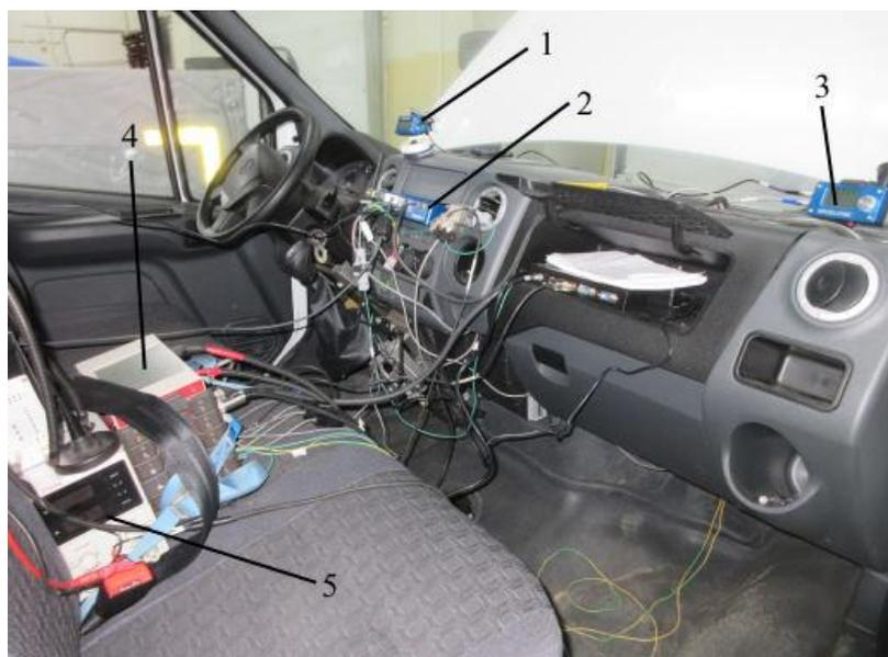
Рис. 5. Установка регистрирующего оборудования в кабине транспортного средства:
