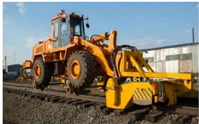
Рис. 1. Комплекс путевой универсальный КПУ-1 с блоком очистки верхней постели
