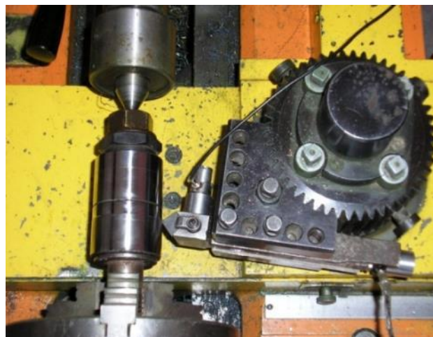
Рис. 7. Схема установки датчика вибраций
