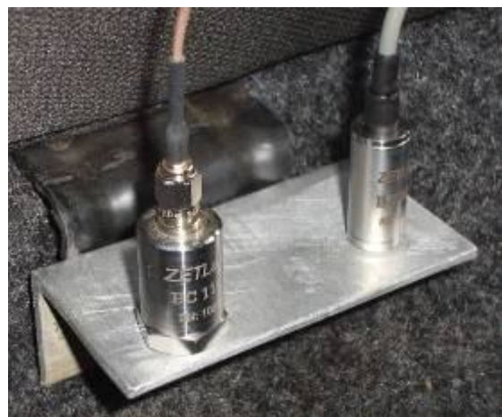
Рис. 8. Установка акселерометров BC 110 и BC 210 в салоне автомобиля ВАЗ-2115
