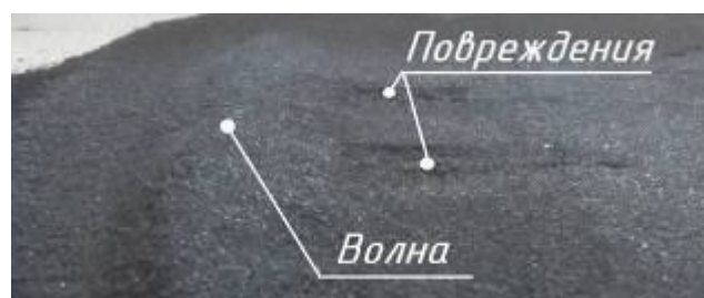
Рис. 5. Результаты испытания при резком торможении вальца за 0,4 с
