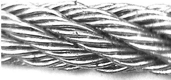
Рис. 6. Образец № 2 каната двойной свивки диаметром 3,4 мм 4 мм изготовленный с равномерным натяжением прядей
