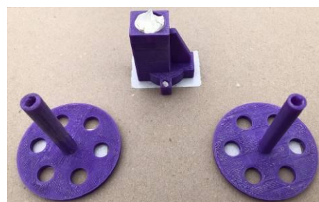
Рис.12. Фиксация деталей на подложке двухсторонним скотчем
