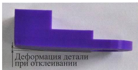
Рис. 5. Отклеивание и деформация угла печатаемой детали
