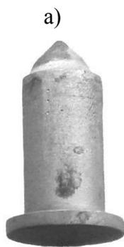
Рис. 5. Исследование бетонного блока экспресс-методом: а – диаграмма вдавливания индентора в стенку скважины в бетонном блоке; б – используемый индентор
