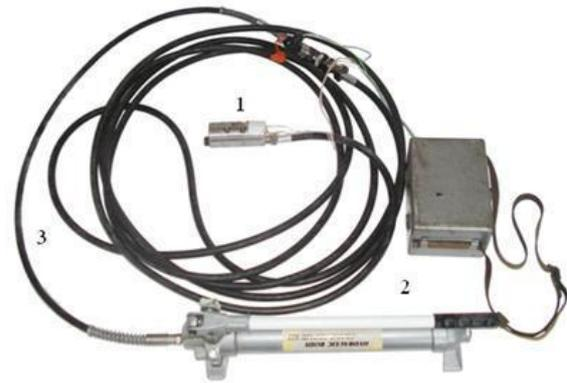
Рис. 1. Устройство «Прочностномер ПСШ-1»
