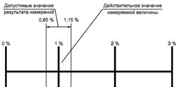
Рис. 1. Пример неопределенности измерений несимметрии напряжений
