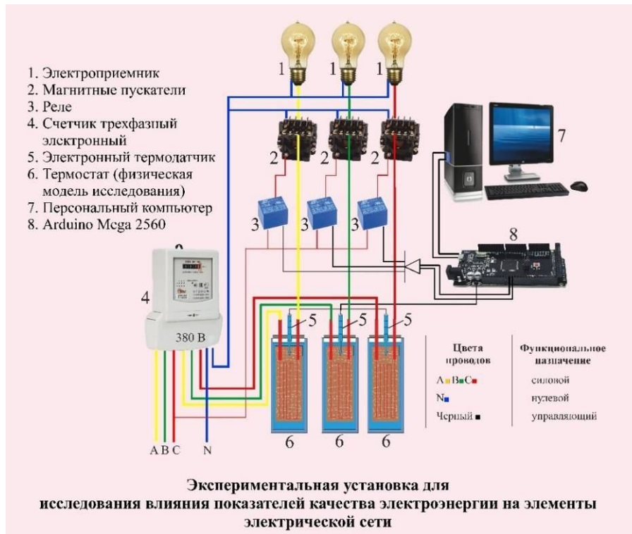
Рис. 6. Экспериментальная установка для исследования влияния показателей качества электроэнергии на элементы электрической сети
