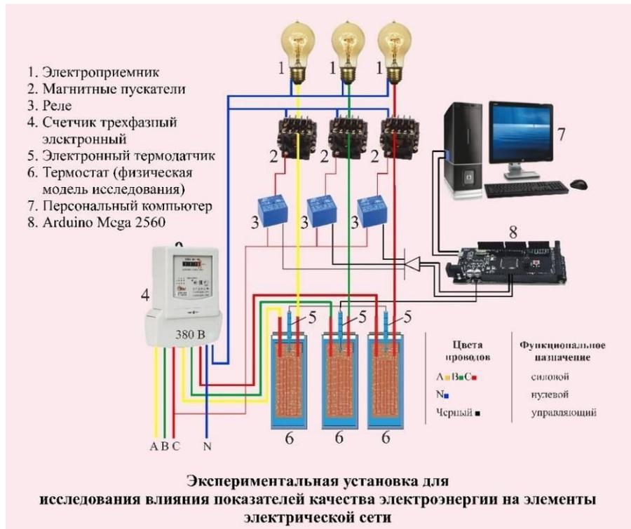
Рис. 6. Экспериментальная установка для исследования влияния показателей качества электроэнергии на элементы электрической сети
