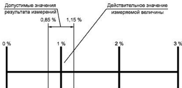
Рис. 1. Пример неопределенности измерений несимметрии напряжений
