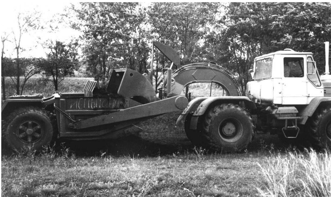
Рис. 1. Полуприцепной скрепер ДЗ-87-1 с шаровым седельно-сцепным устройством
