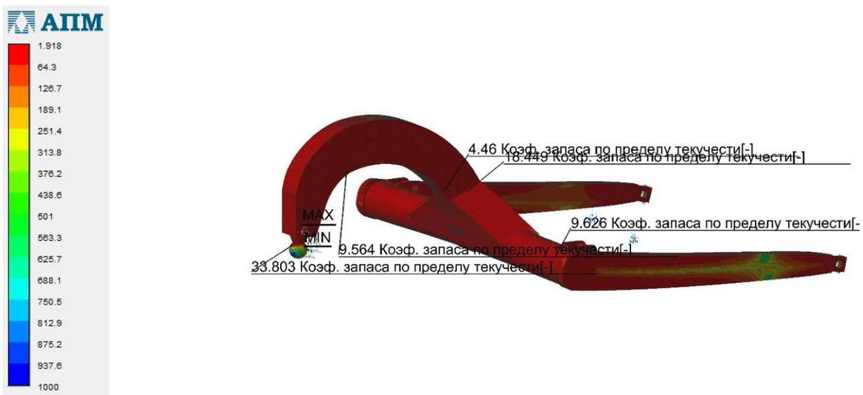
Рис. 11. Коэффициент запаса в тяговой раме при копании грунта (тяговая нагрузка передается сразу на ковш)
