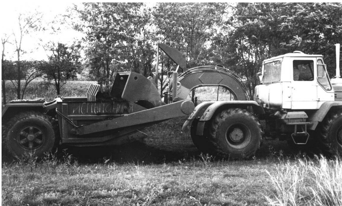
Рис. 1. Полуприцепной скрепер ДЗ-87-1 с шаровым седельно-сцепным устройством
