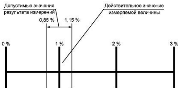
Рис. 1. Пример неопределенности измерений несимметрии напряжений
