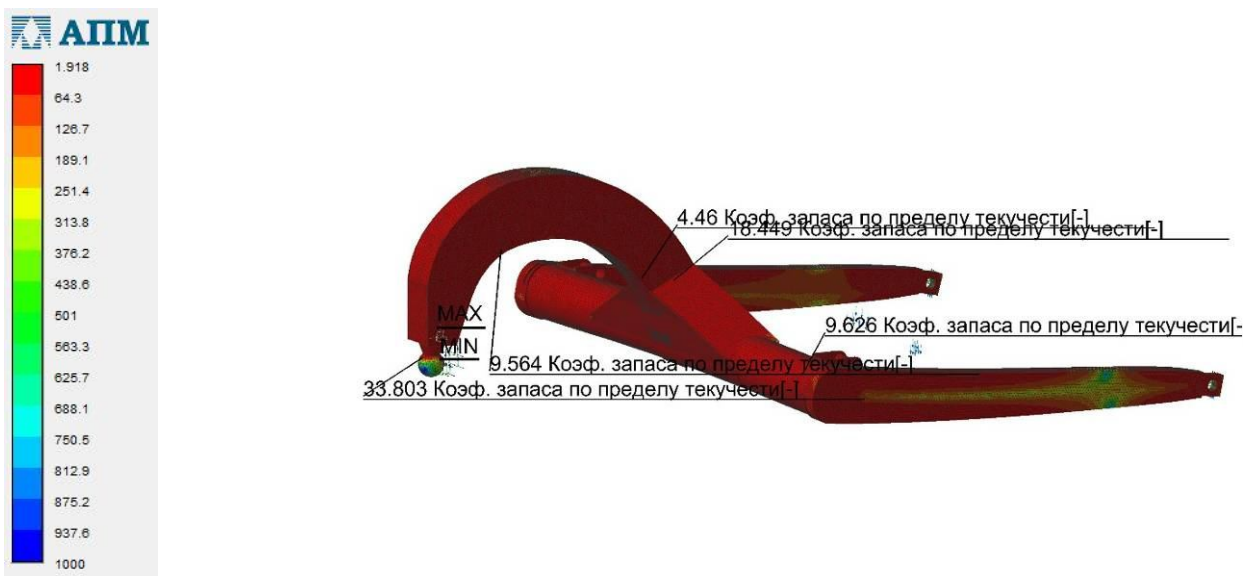
Рис. 11. Коэффициент запаса в тяговой раме при копании грунта (тяговая нагрузка передается сразу на ковш)
