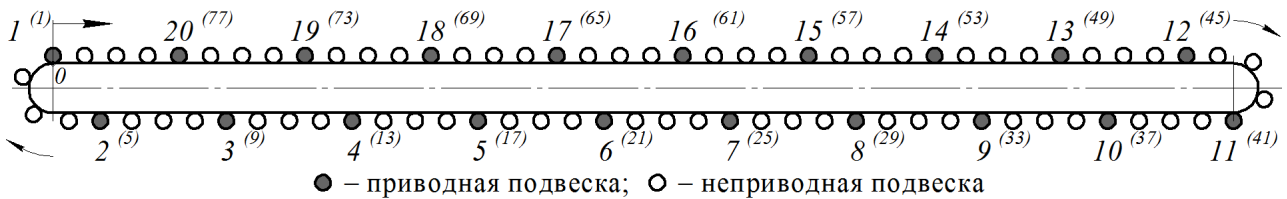
Рис. 3. Схема исходного расположения подвесок конвейера с подвесной лентой и распределенным приводом на трассе
