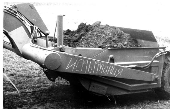
Рис. 4. Заполнение ковша при самонаборе грунта
