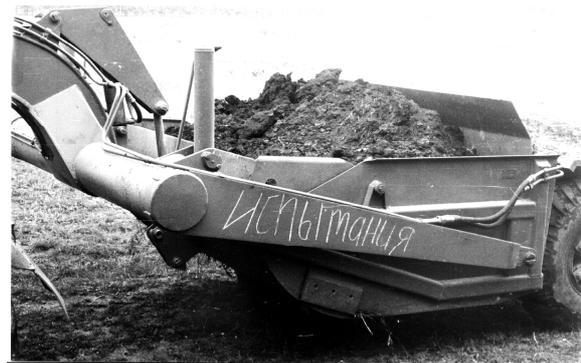
Рис. 4. Заполнение ковша при самонаборе грунта
