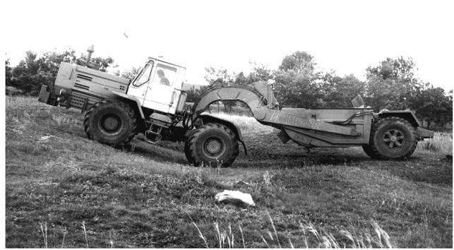
Рис. 3. Опытный образец скрепера ДЗ-87-1
