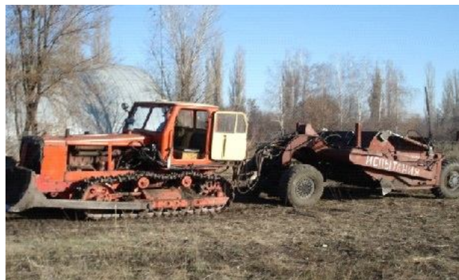
Рис. 3. Опытный образец скрепера с комбинированной ножевой системой на базе скрепера ДЗ-111
