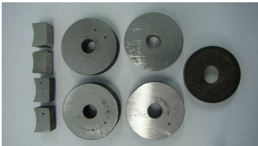
Рис. 1. Алмазный круг АСО 125/100 100% М1 (тёмный), диски и колодочные образцы из стали 45 HV1800
