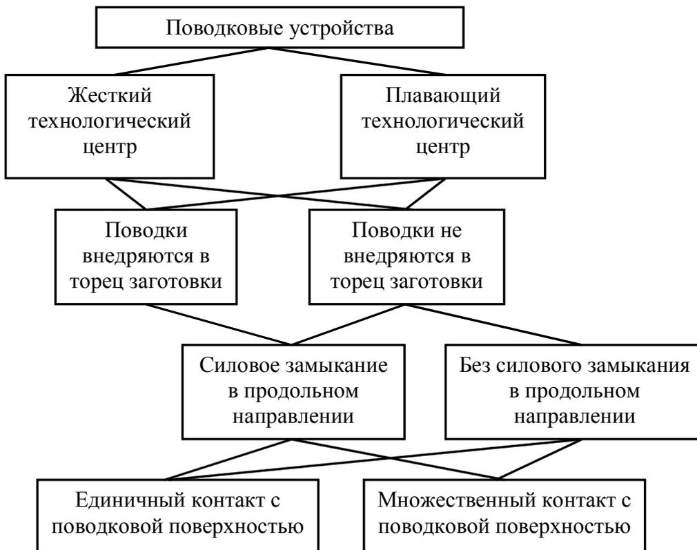
Рис. 2. Классификация поводковых устройств из условия обеспечения конструктивных показателей качества
